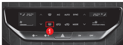
Dégivrage du rétroviseur extérieur
